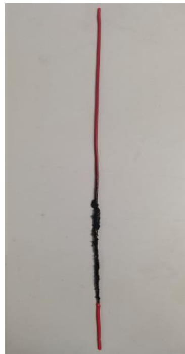
图 8 燃烧后的电线
