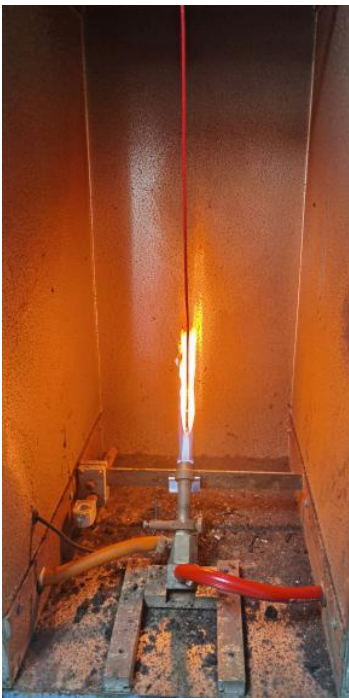
图 7 不延燃试验场景
